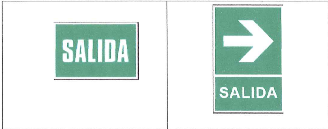
Figura 03. Señales de salida de emergencia
