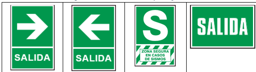
Figura 3: Señales de evacuación y emergencia estandarizadas
