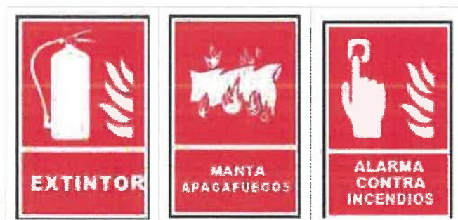
Figura 05. Señales que indican equipos de Protección
