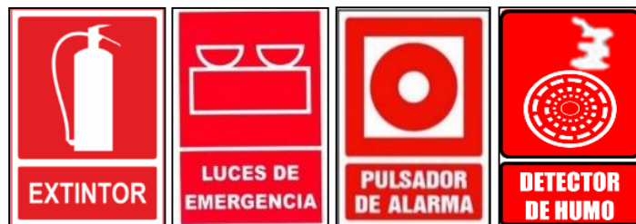
Figura 06. Señales que indican equipos de Protección
